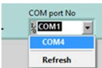
По умолчанию – COM1. Чтобы увидеть номер подключенного порта, разверните меню, при необходимости нажмите Refresh (Обновить). Если в системе много COM портов, проверьте в Менеджере Устройств какой именно номер присвоен Prolific COM-USB конвертору (при подключении к другому разъему USB номер COM порта изменяется).
