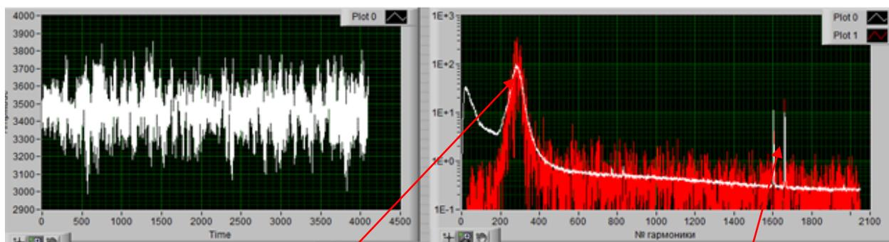
Здесь помимо полезного сигнала присутствует электромагнитная помеха, причем на двух частотах. Смотрим номера гармоник помехи – и устанавливаем подавление средней частоты и ее ширину  $\pm$  слева-справа (с запасом)
